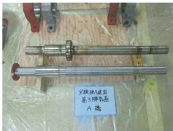
排風機 A 号機の軸 (旧品：上、現行品：下)
