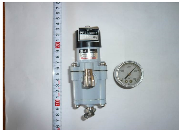
写真 2.1.7-2 排気第 4 系統負圧制御用バタフライ弁の減圧弁 (圧力計は指示不良)
